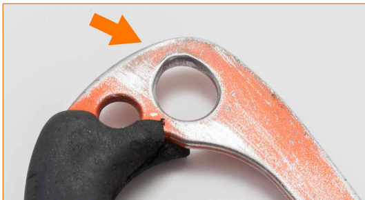
Corps usé à proximité du trou de connexion inférieur.
