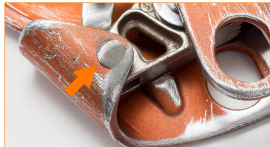
Axe de rotation de la came de blocage fortement usé.
