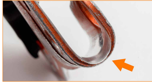
Corps très usé dans la zone de coulissement de la corde.
