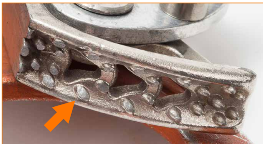
Came de blocage avec des dents manquantes et cassées à cause d'une forte usure et des utilisations inappropriées.
