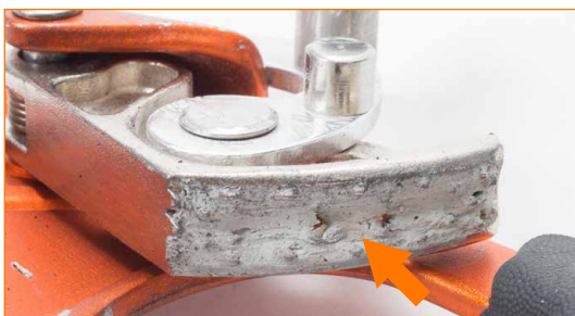
Came de blocage avec des dents manquantes et cassées à cause d'une forte usure et des utilisations inappropriées.
