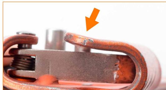
Corps déformé en raison de l'accumulation de la gaine de la corde suite à une chute avec \text{Facteur} > 1 .
