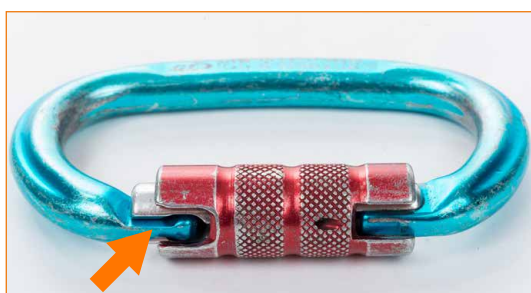
Conector con casquillo que no vuelve de manera automática en posición de bloqueo. 🗝️ Lubricar el casquillo como indicado en las instrucciones de uso. Si el problema no se resuelve, retirar el equipo.
