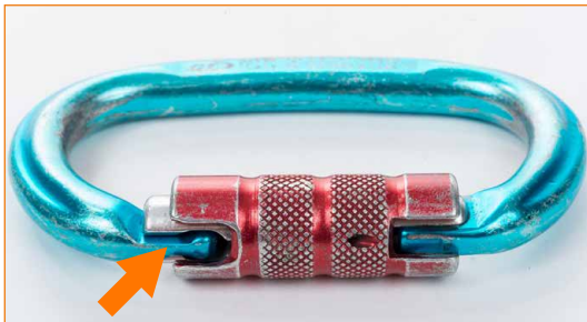
Connettore con leva che presenta eccessivo gioco laterale.
