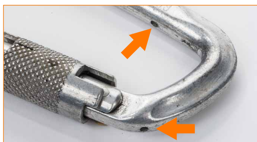
Verbindungselement mit fehlendem Stäbchen.
