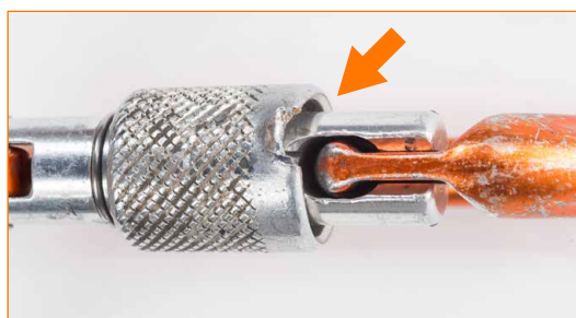
Verbindungselement mit stark beschädigtem Schraubverschluss.
