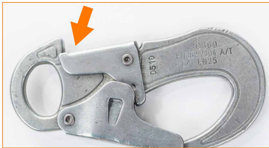
Connettore a doppia leva con leva di sicurezza posteriore che non torna in posizione automaticamente.
