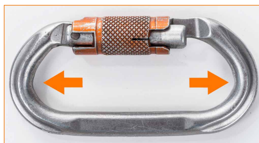
Verbindungselement mit äußerst verformtem Schraubglied durch eine unkorrekte Anwendung.
