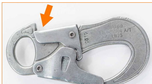
Conector de doble gatillo con gatillo de seguridad posterior que no vuelve en posición de manera automática.
