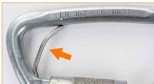
Verbindungselement mit verformtem Stäbchen.
