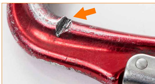
Verbindungselement mit offensichtlich scharfer Einkerbung auf dem Körper.
