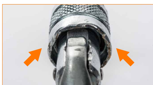
Conector con cierre de rosca extremadamente dañado.
