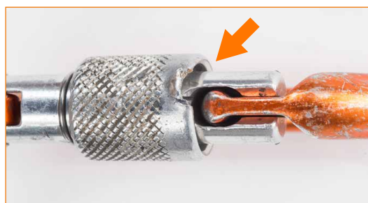
Conector con cierre de rosca muy dañado.
