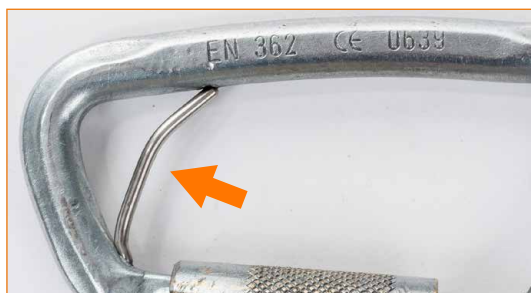
Conector con barra cautiva deformada.
