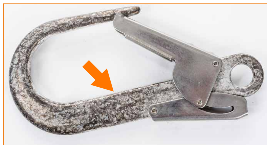
Verbindungselement mit Doppelschnapper mit offensichtlichen Korrosionsanzeichen.
