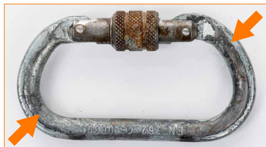
Conector con cierre de rosca con evidentes signos de oxidación.
