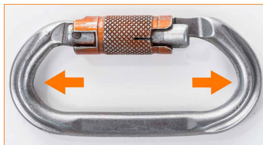
Conector con cierre de rosca extremadamente deformado debido a un uso incorrecto.
