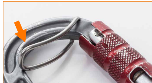
Connettore con levetta ACL deformata.
