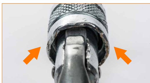
Verbindungselement mit äußerst beschädigtem Schraubverschluss.
