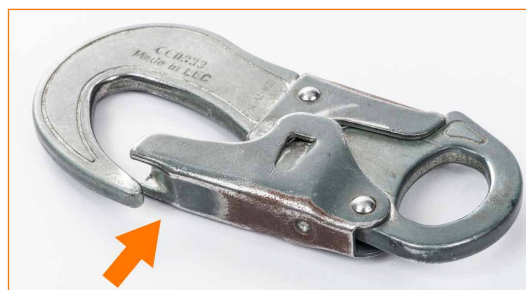
Verbindungselement mit Oxidation, diese behindert die Funktionstüchtigkeit der Verschlusschnapper.
