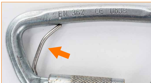
Connettore con barretta deformata.
